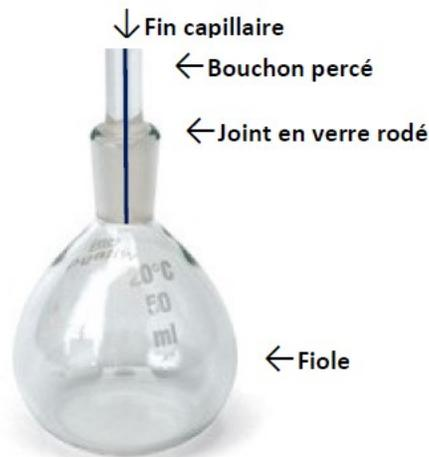
Figure 3c : Pycnomètre
