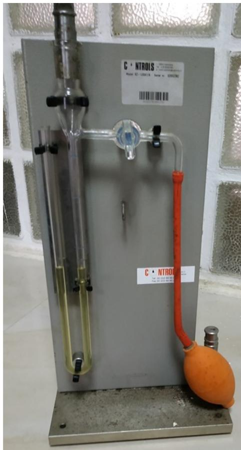
Figure 4c : Perméabilimètre de Blaine
