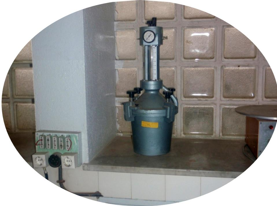
Photo 1e : Aéromètre à béton
