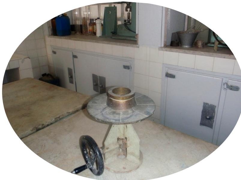
Photo 2.e: Mesure de l'étalement du béton
