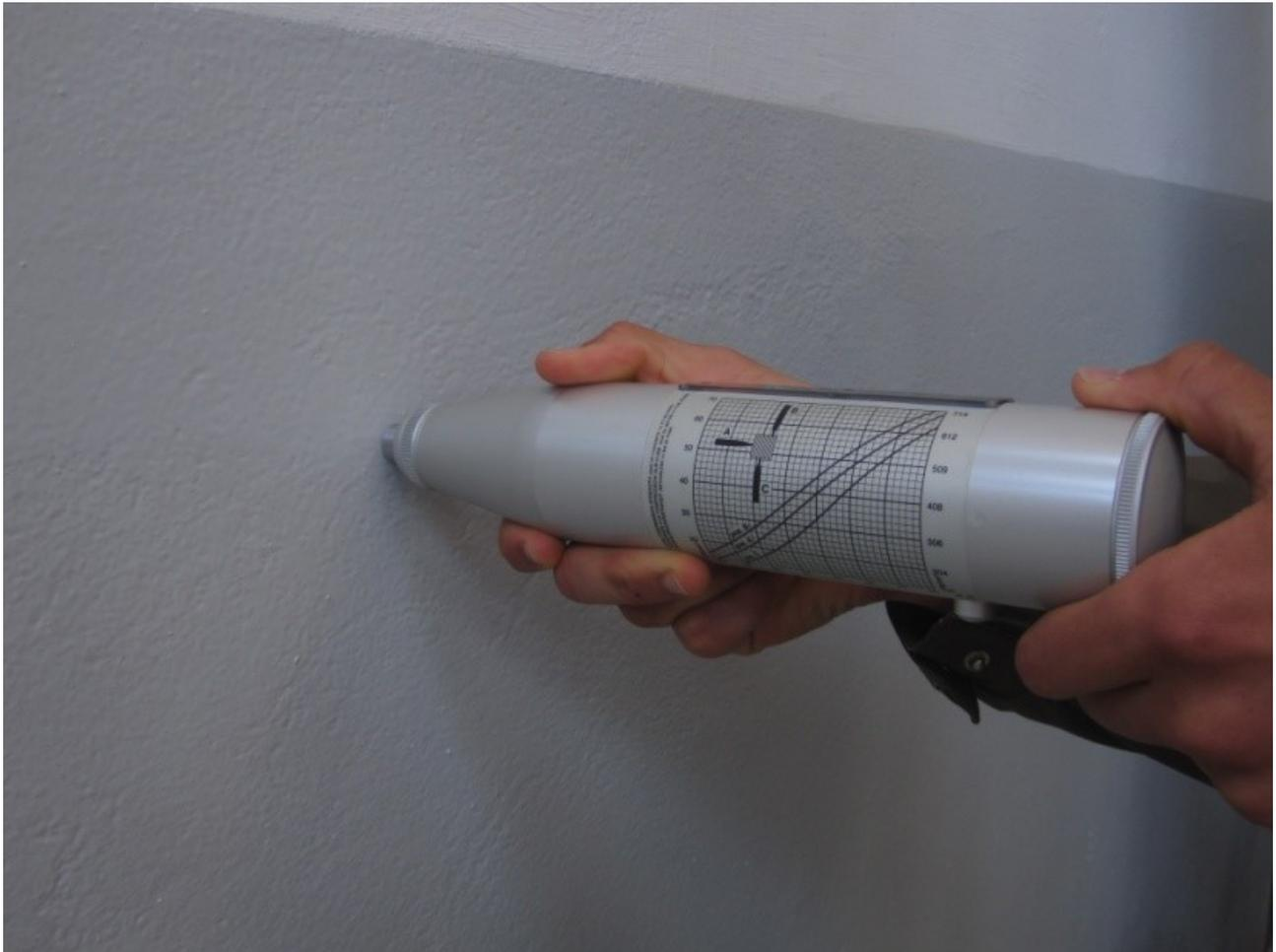
**Essai de dureté de surface au scléromètre
